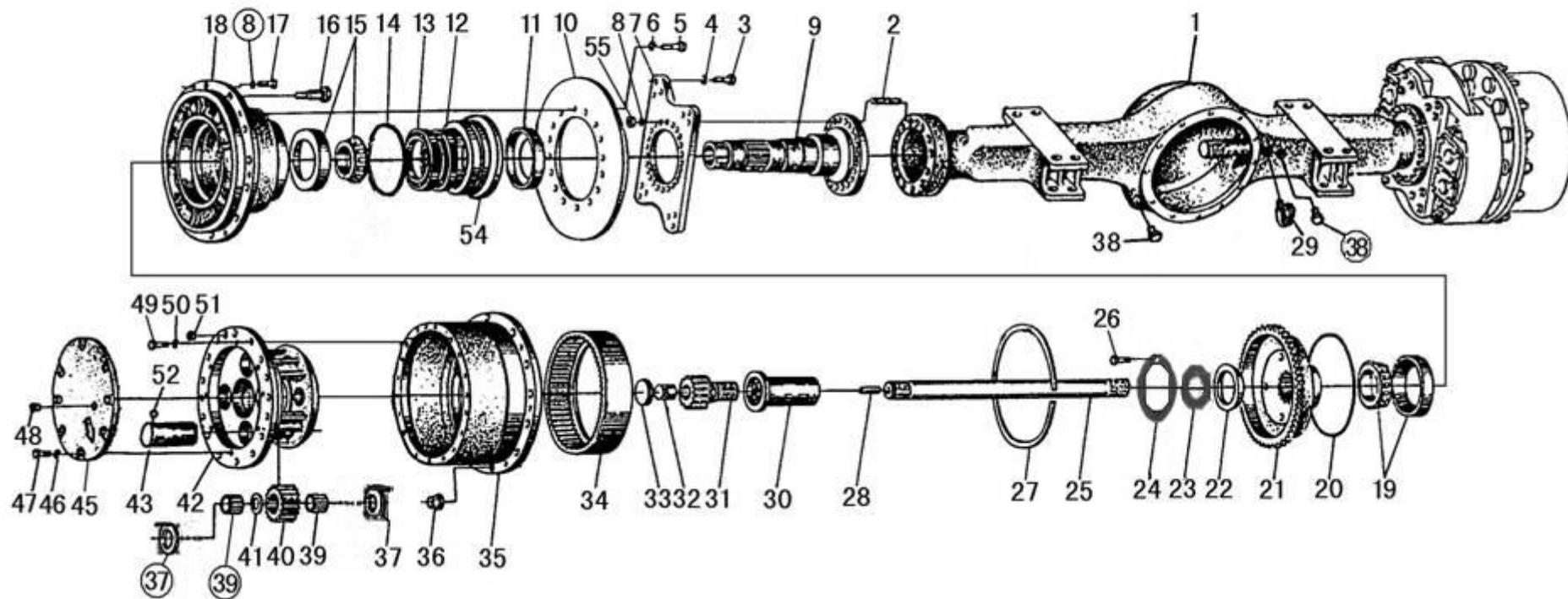
后驱动桥总成(659) AXLE ASSEMBLY
