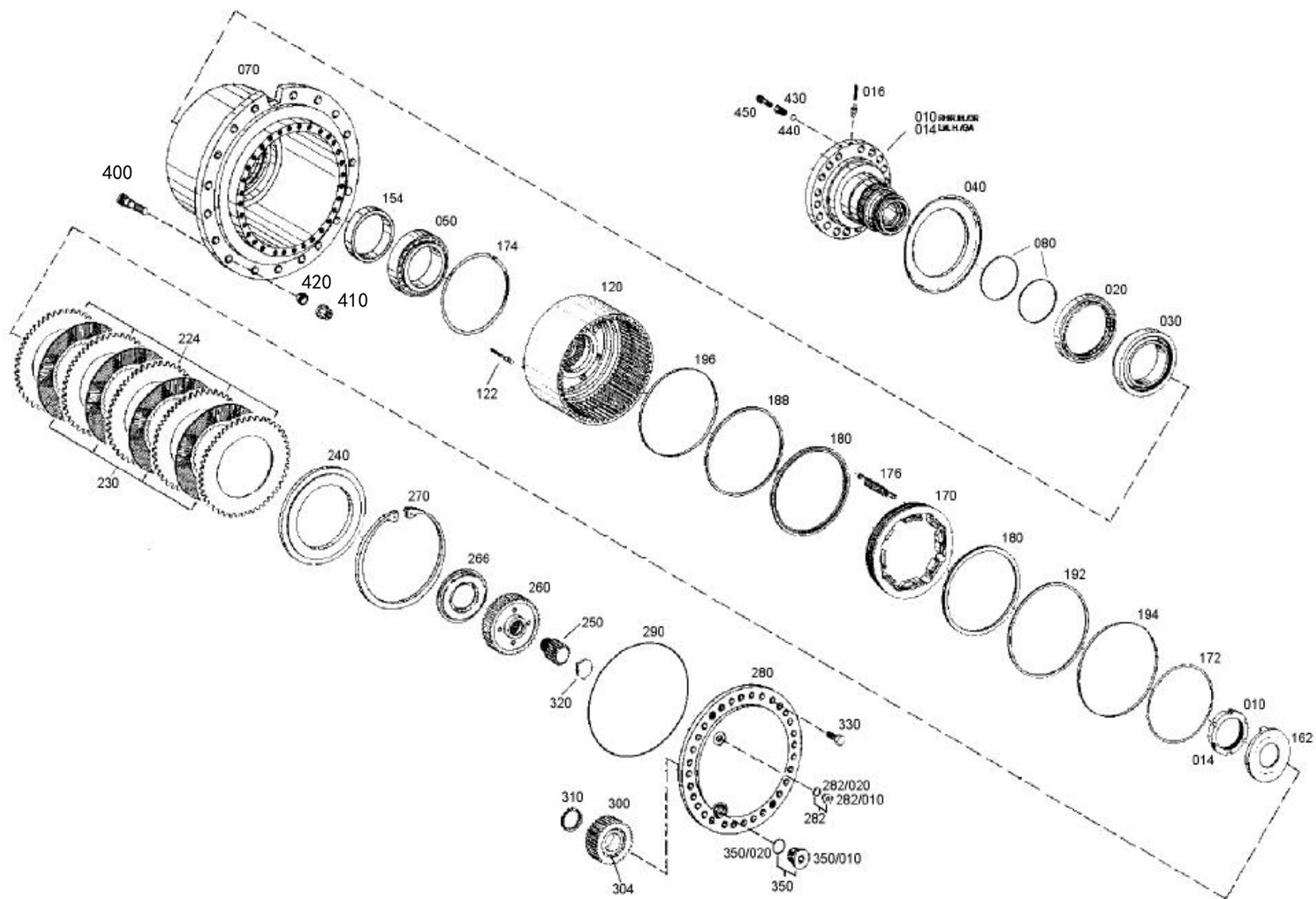
前桥 输出部分 OUTPUT, FRONT AXLE
