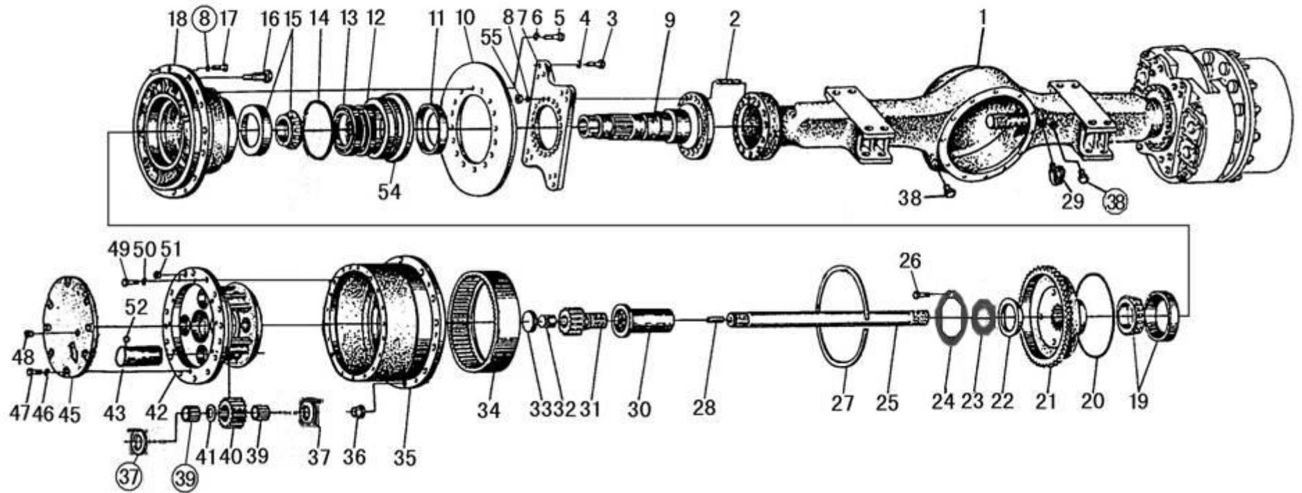
后驱动桥总成(659) AXLE ASSEMBLY
