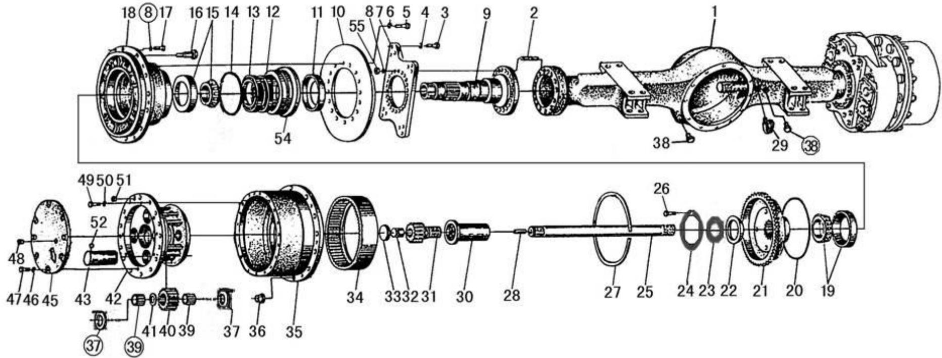
后驱动桥总成(659) AXLE ASSEMBLY
