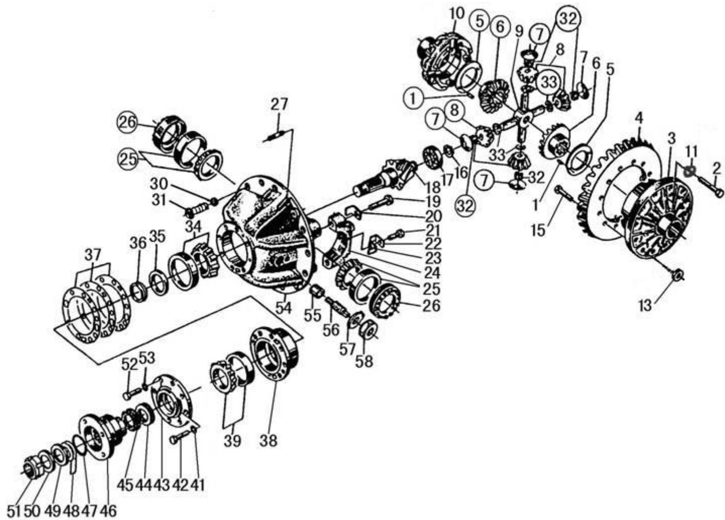
主减速器总成(659)MAIN REDUCER ASSEMBLY
