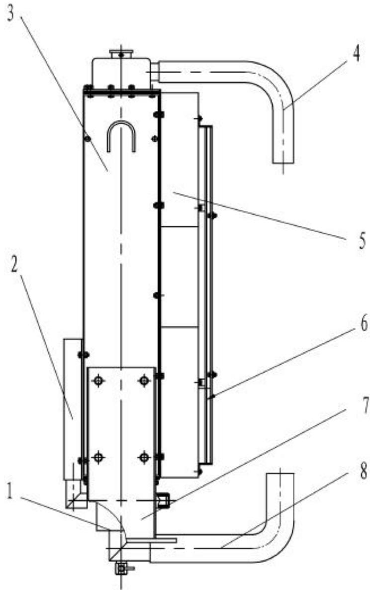
冷却系统(配 6121 发动机) COOLING SYSTEM (FOR C6121 ENGINE)
