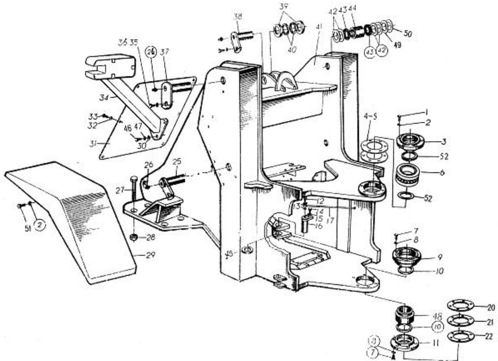
前车架总成 FRONT FRAME ASSEMBLY
