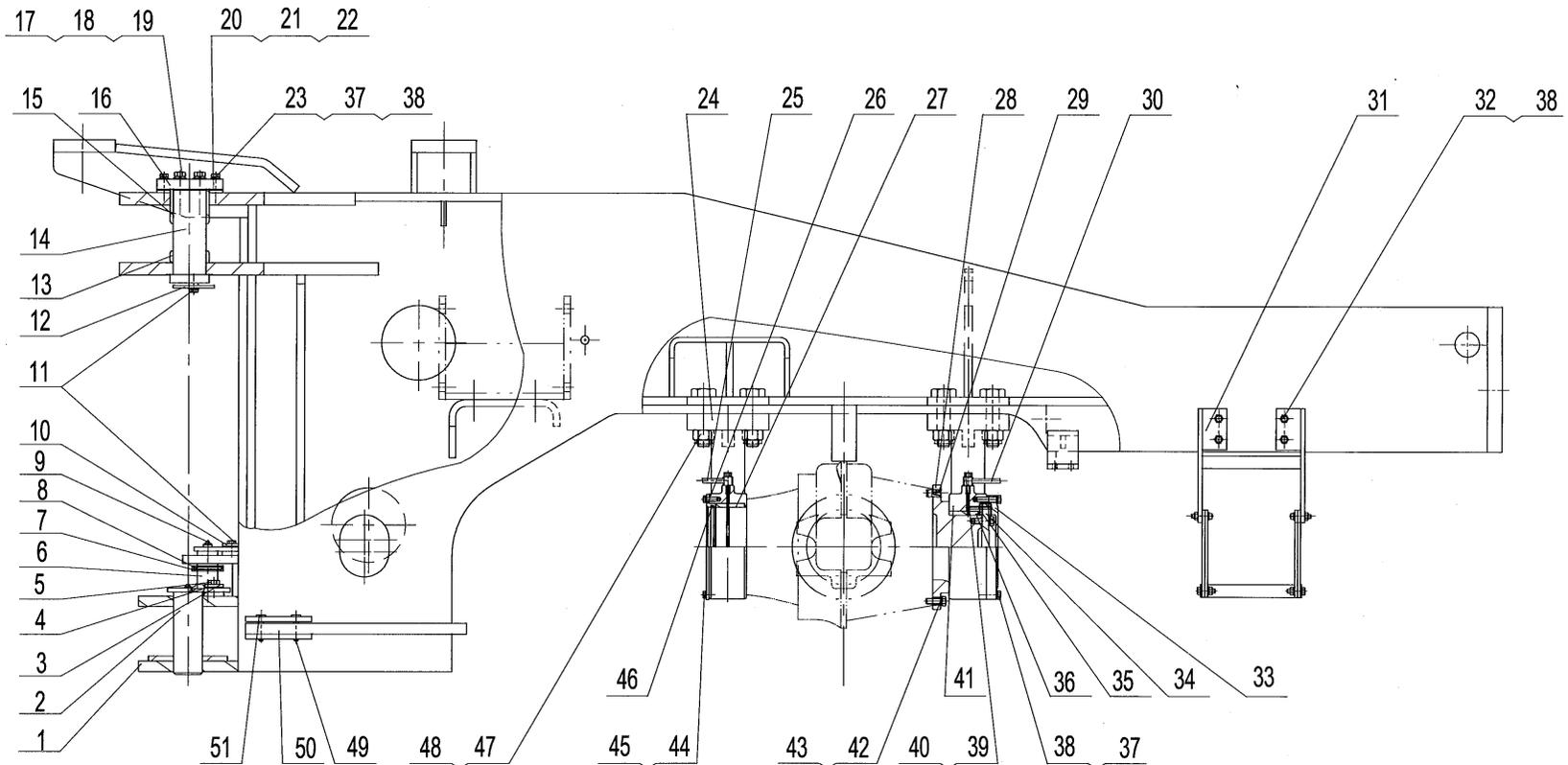
后车架总成 (658) REAR FRAME ASSEMBLY
