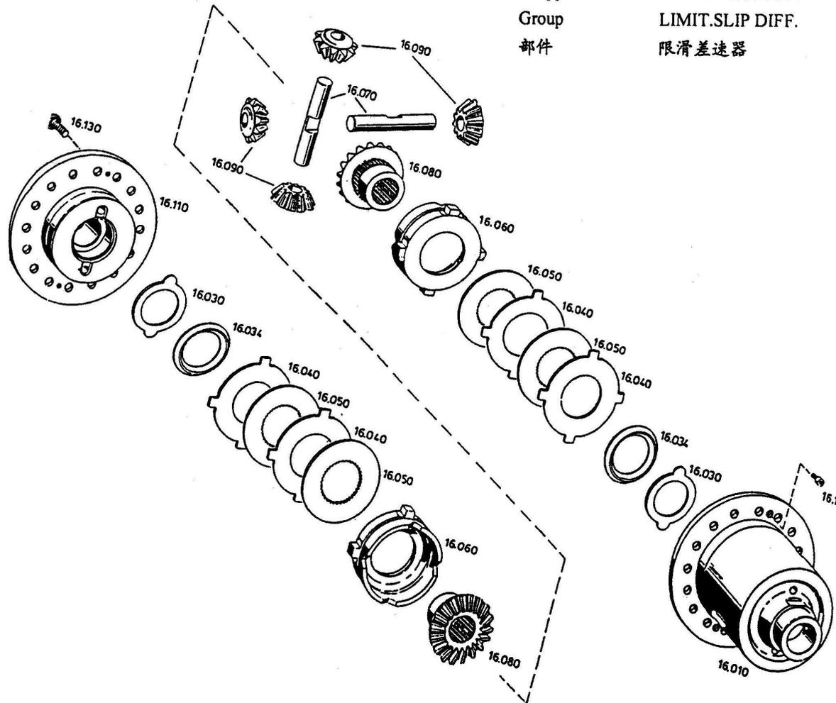
前桥 限滑差速器 SLIDE-LIMITED DIFFERENTIAL, FRONT AXLE
