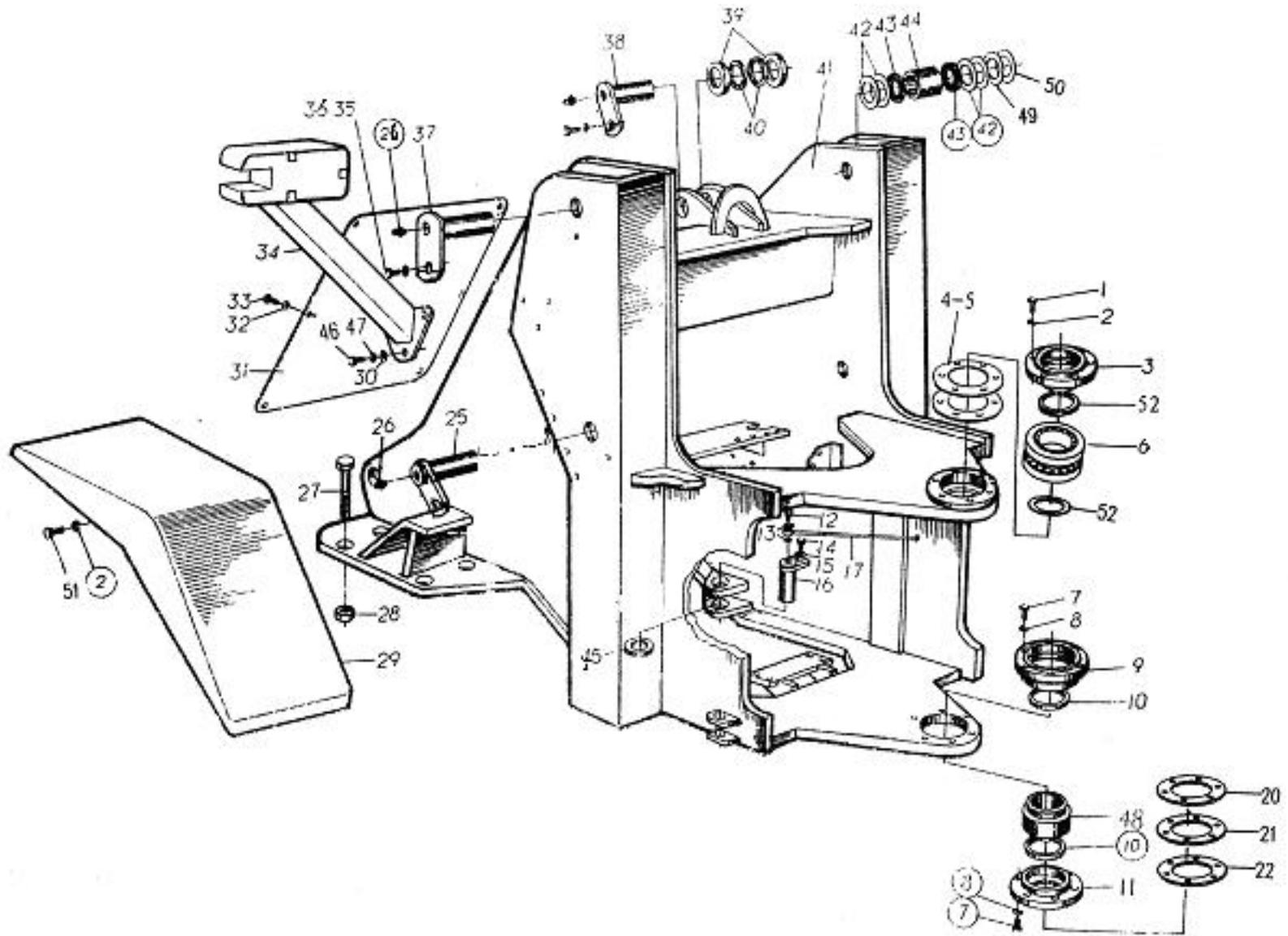
前车架总成 FRONT FRAME ASSEMBLY
