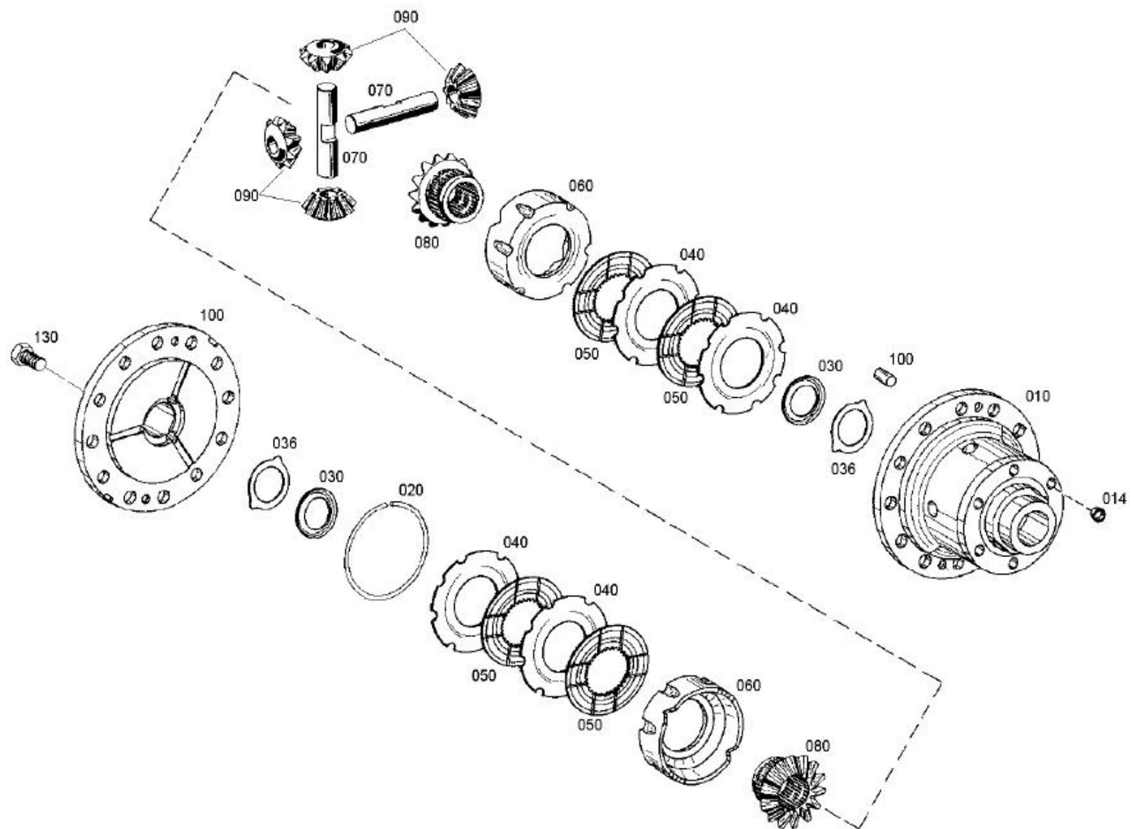
**后桥 限滑差速器 SLIDE-LIMITED DIFFERENTIAL, REAR AXLE**
