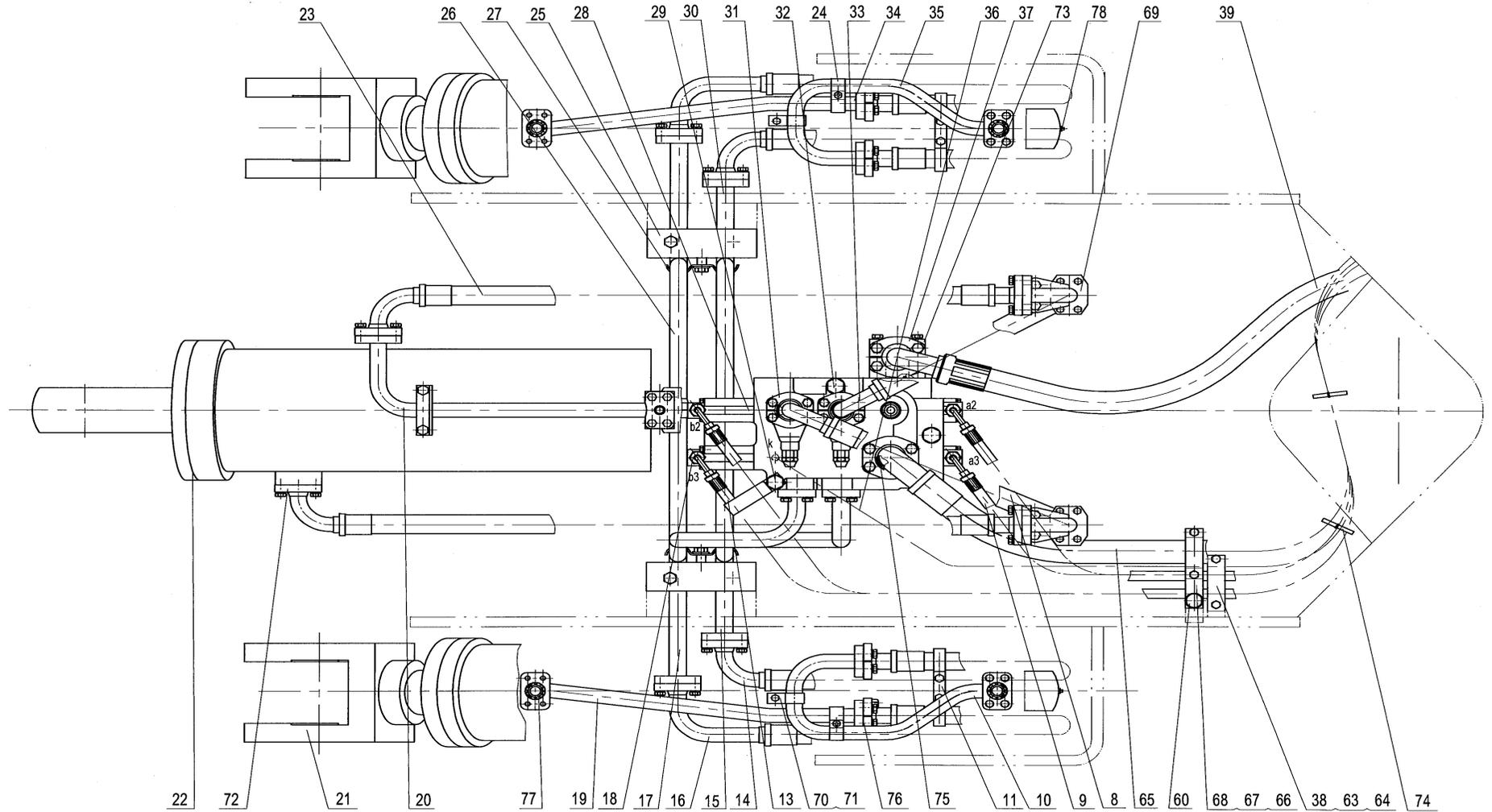
工作装置液压系统 WORKING DEVICE HYDRAULIC SYSTEM
