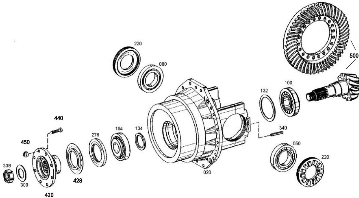
后桥 主传动总成 MAIN TRANSMISSION, REAR AXLE
