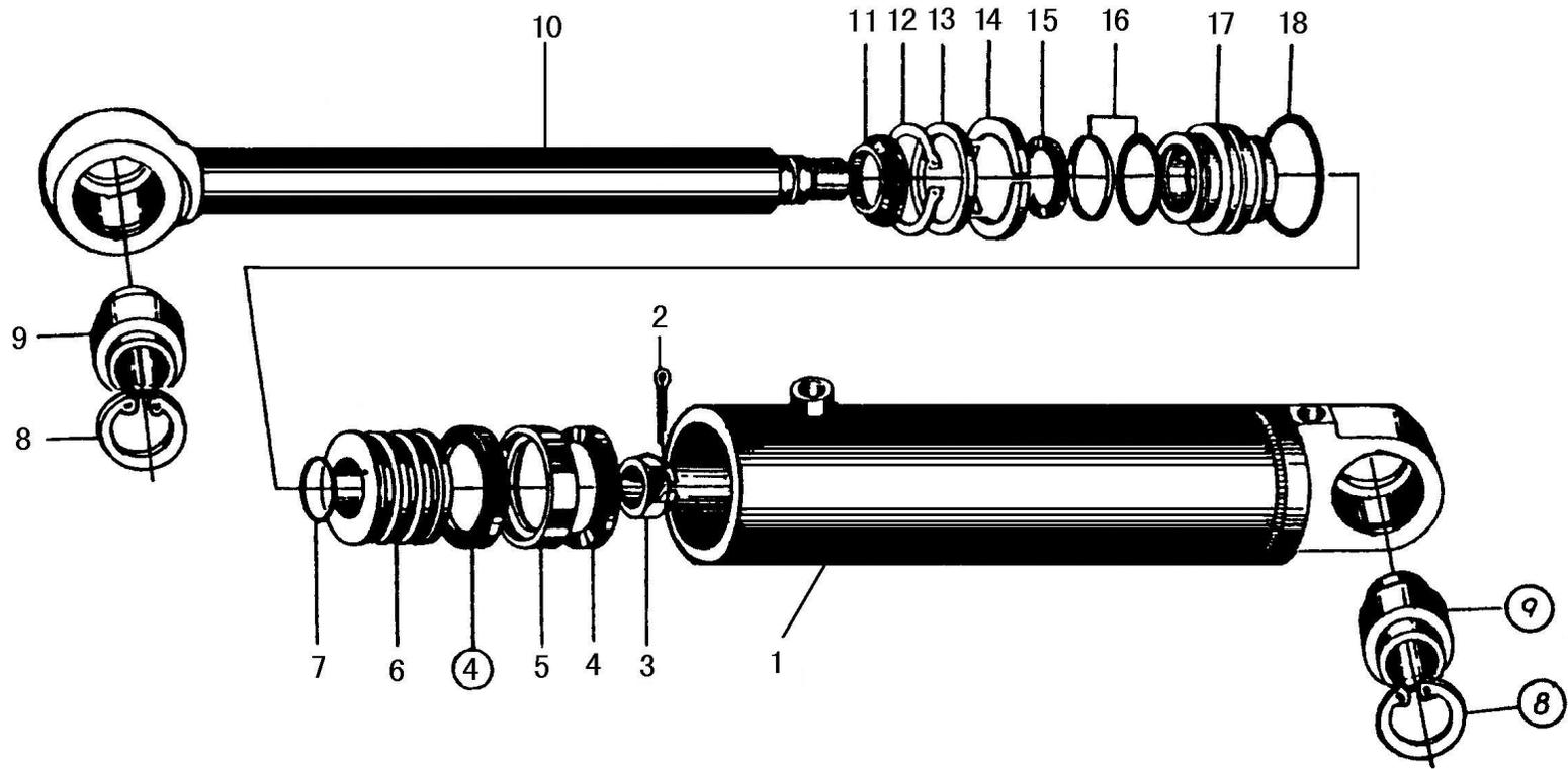
转向油缸 STEERING CYLINDER ASSEMBLY
