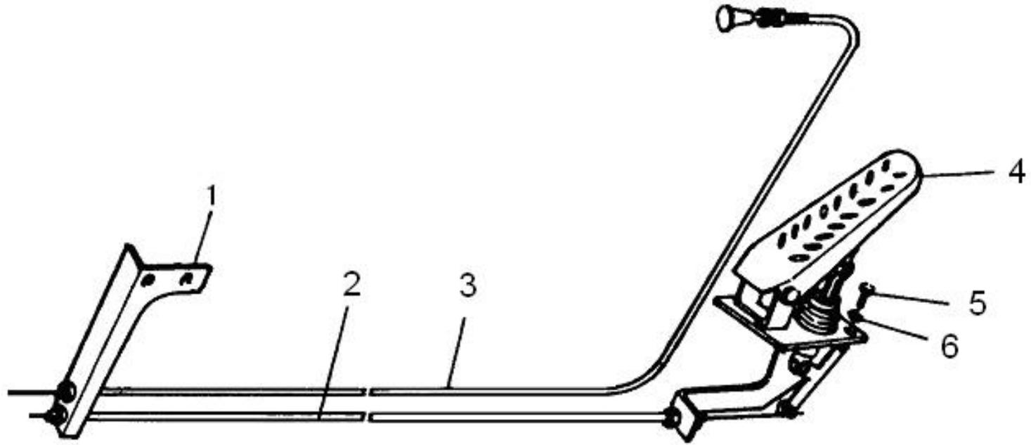
加油机构 ACCELERATOR MECHANISM
