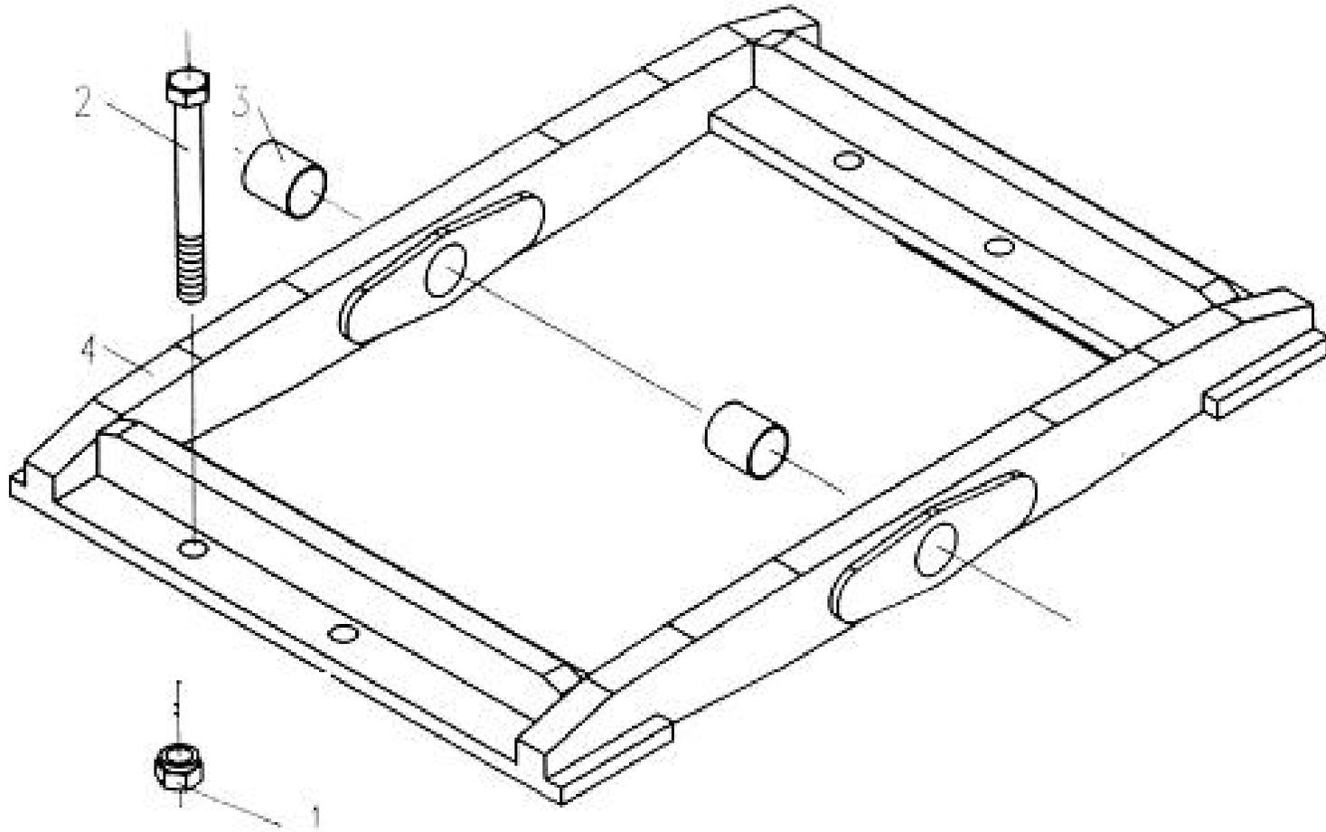
摆动架总成 (659) OSCILLATING FRAME ASSEMBLY
