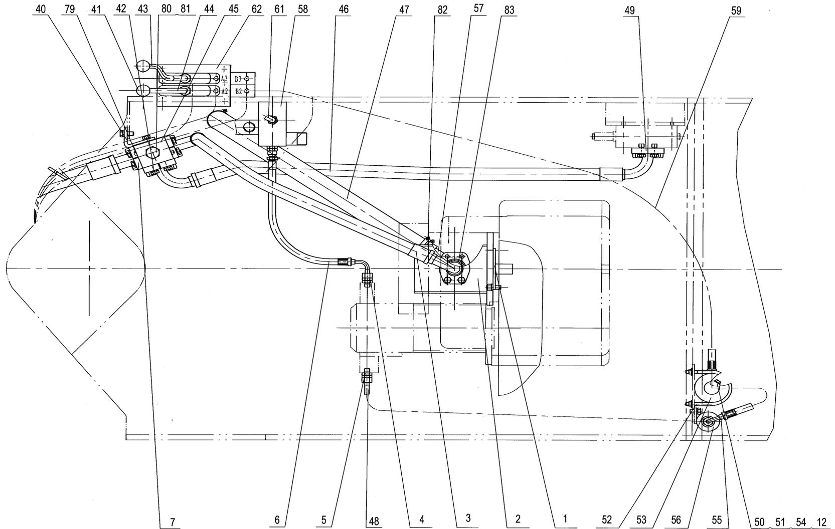
工作装置液压系统 WORKING DEVICE HYDRAULIC SYSTEM
