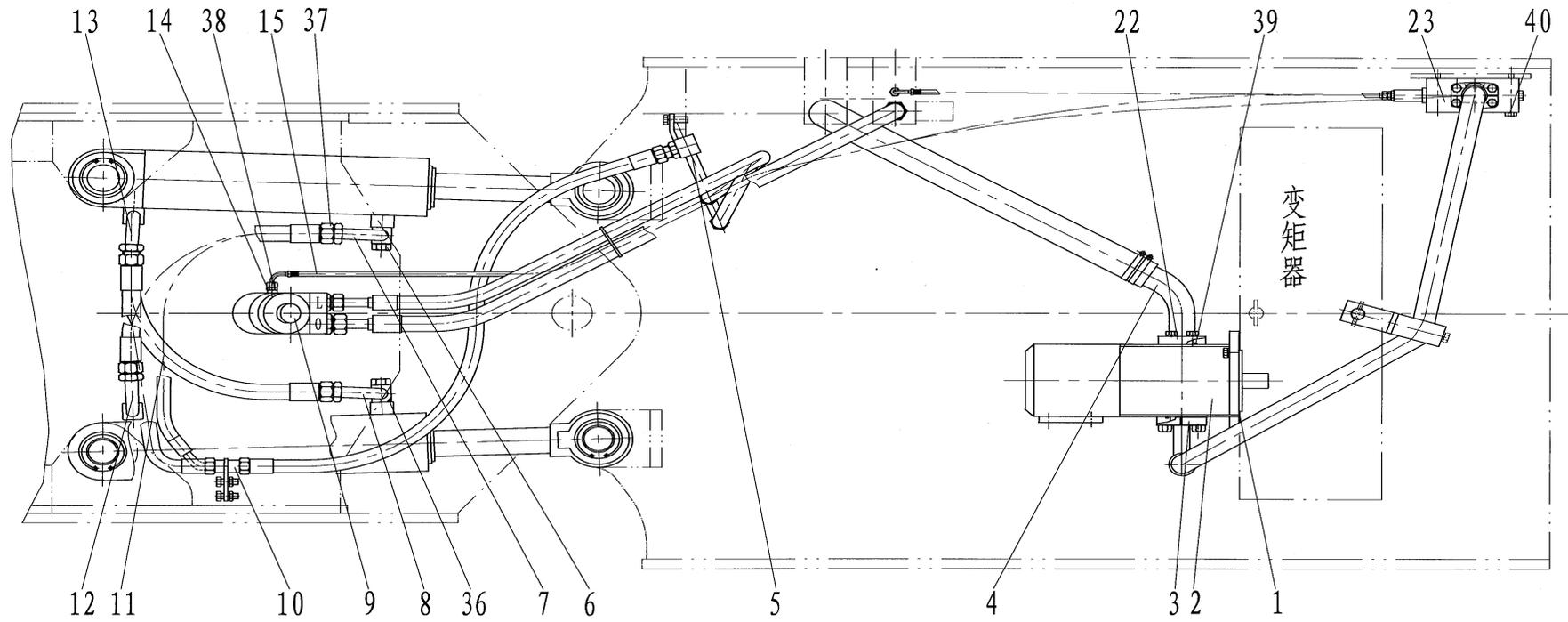
转向液压系统 STEERING HYDRAULIC SYSTEM
