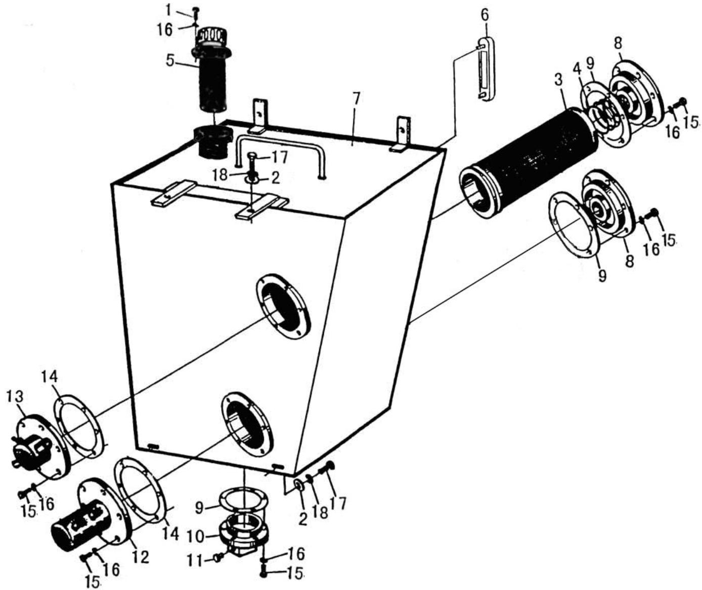
机油箱总成 ENGINE OIL TANK ASSEMBLY
