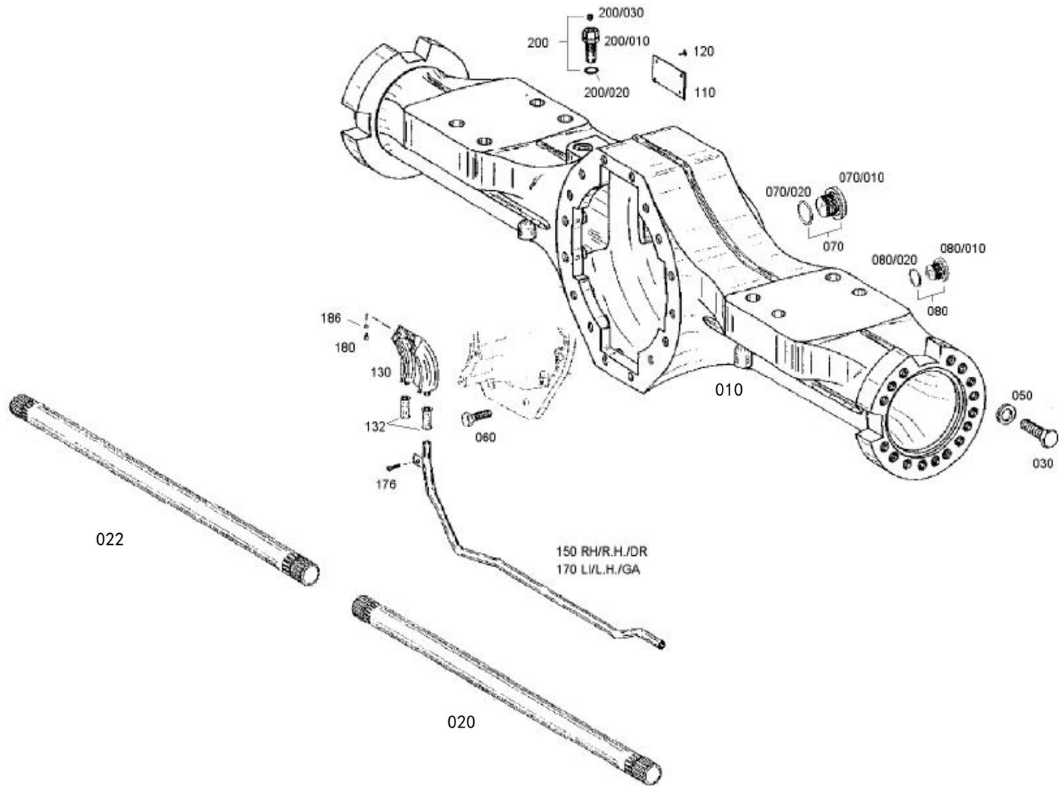
前桥桥壳 AXLE CASE, FRONT AXLE
