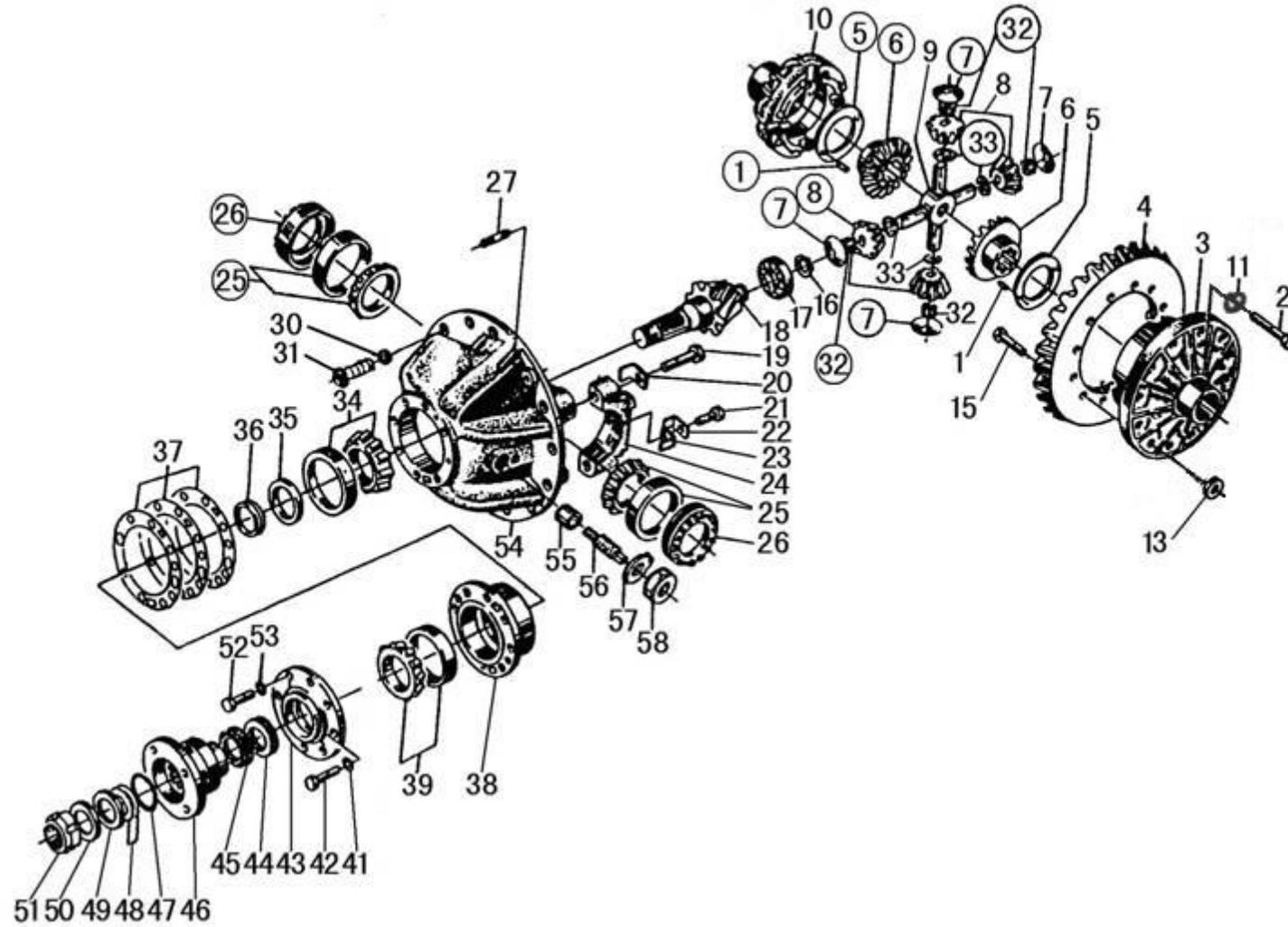
主减速器总成(659)MAIN REDUCER ASSEMBLY
