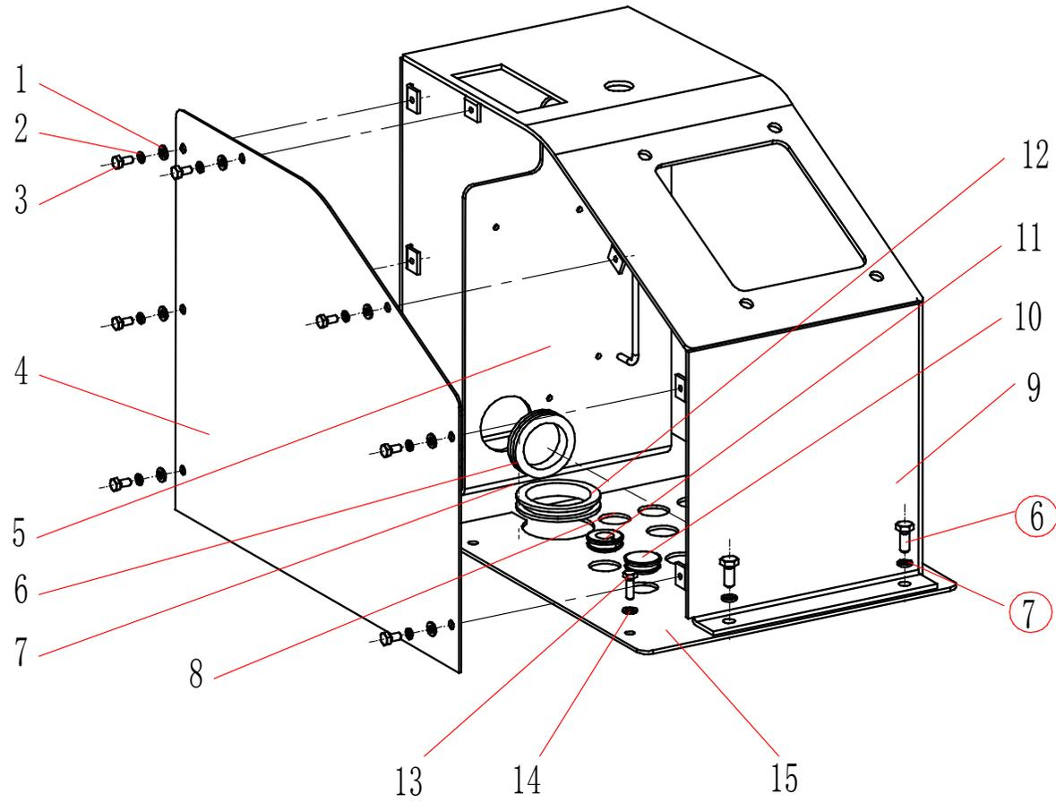
先导阀支架总成(G) Pilot Valve Frame Assembly(G)
