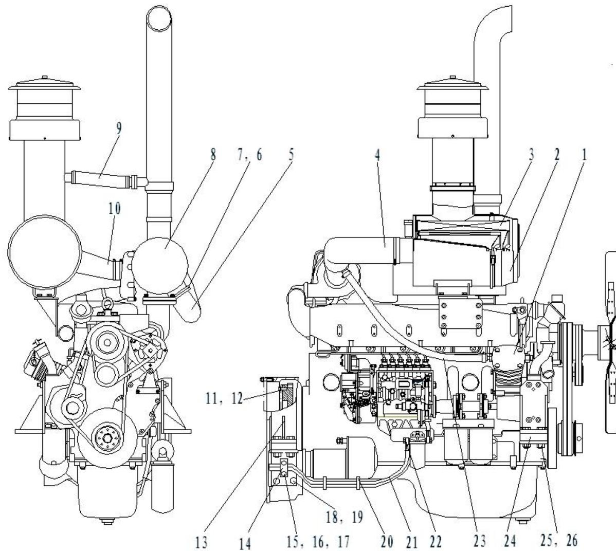
柴油机装置 (WD615G.220) DIESEL ENGINE INSTALLATION
