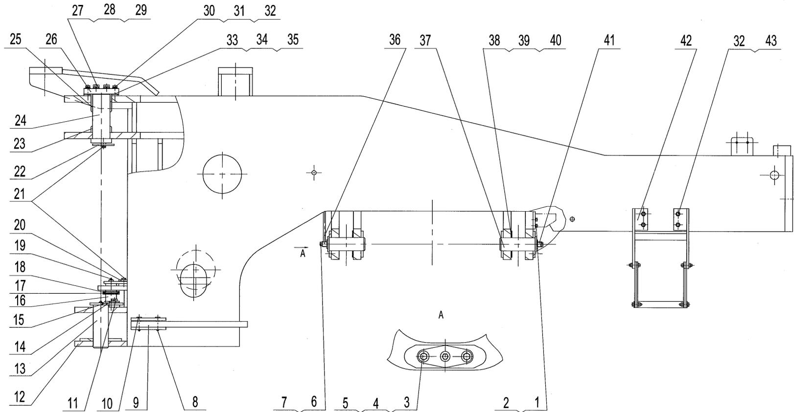
后车架总成 (659) REAR FRAME ASSEMBLY
