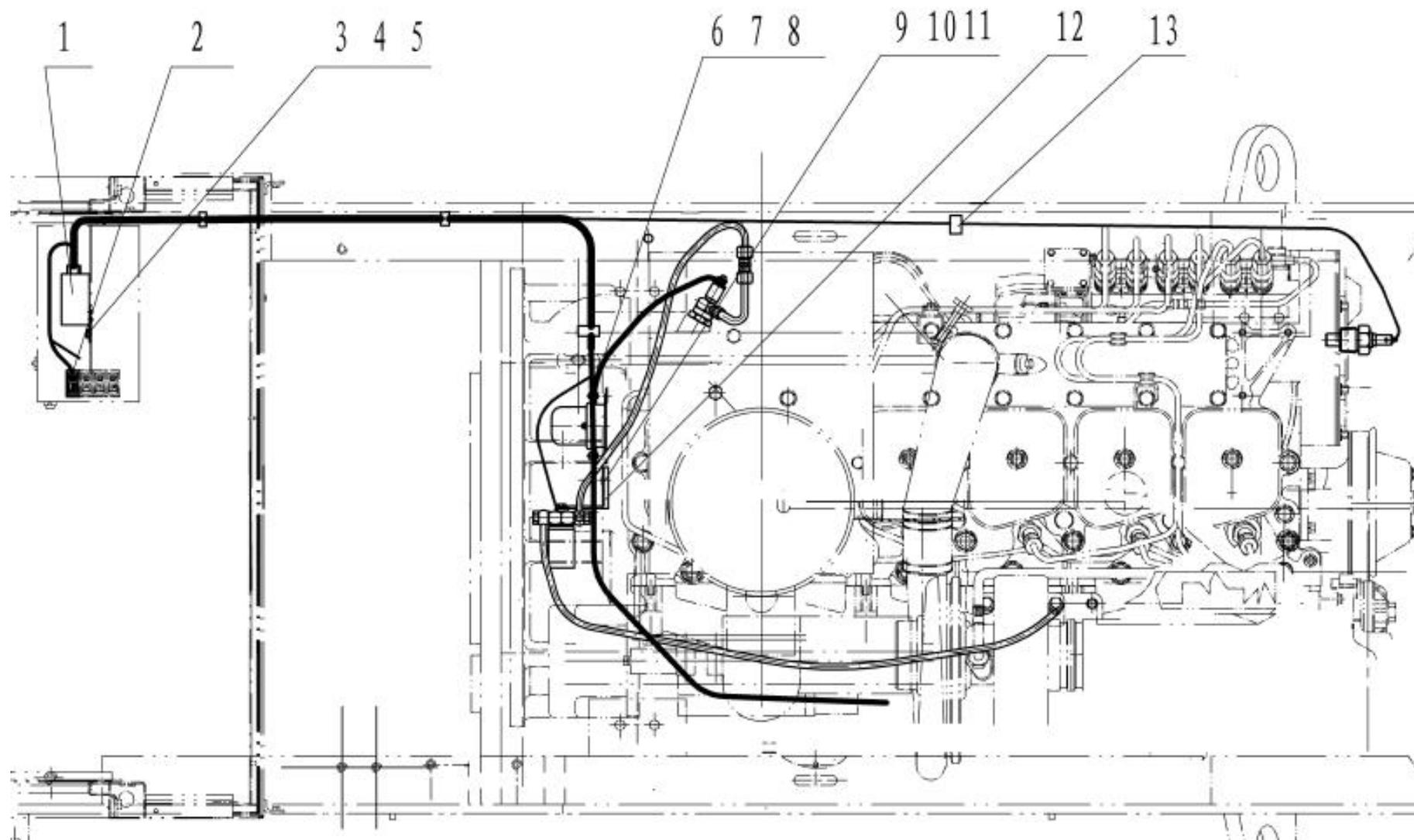
**火焰预热系统(C6121) FIRE HEATER SYSTEM**
