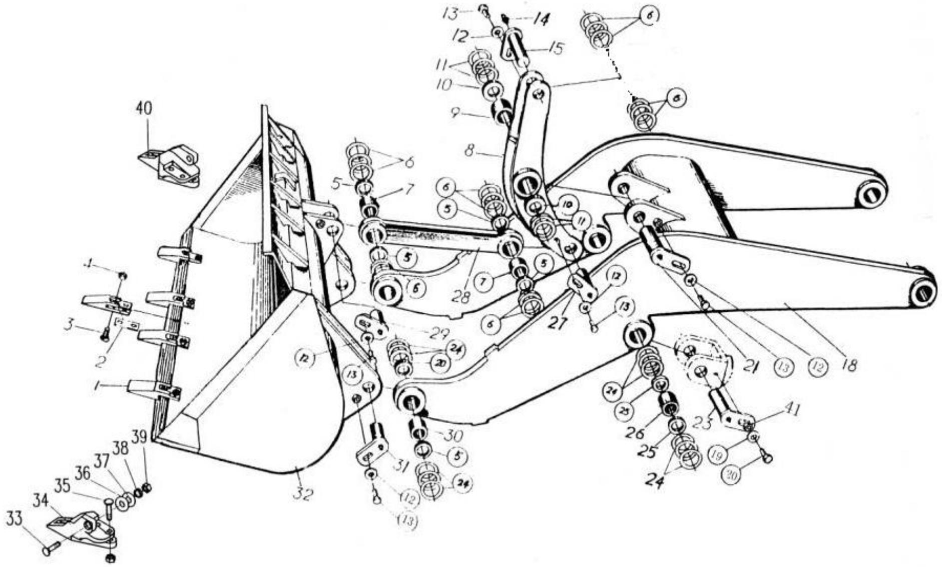
工作装置总成 WORKING EQUIPMENT ASSEMBLY
