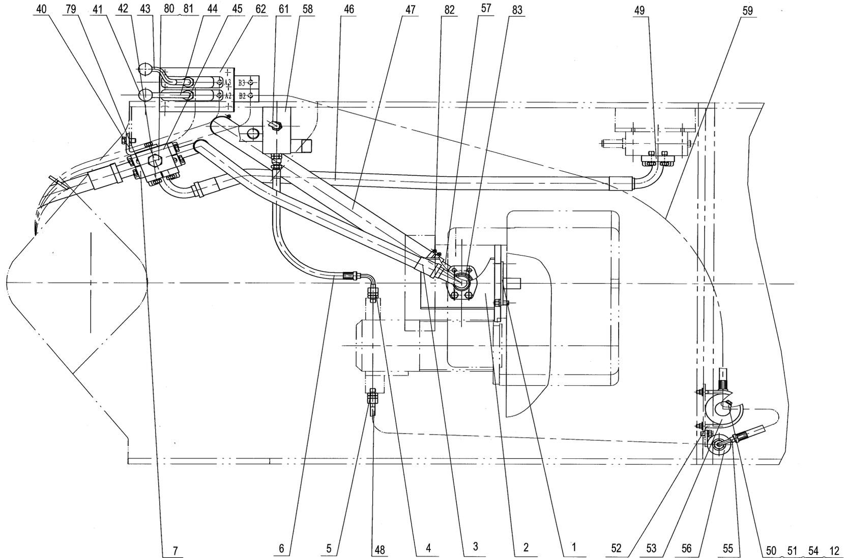
工作装置液压系统 WORKING DEVICE HYDRAULIC SYSTEM
