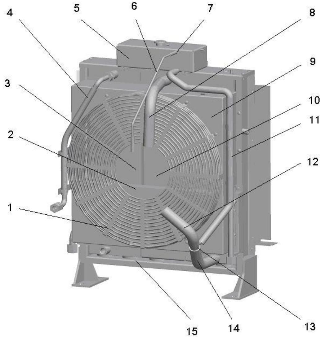
冷却系统(配WD615 发动机) COOLING SYSTEM (FOR WD615 ENGINE)
