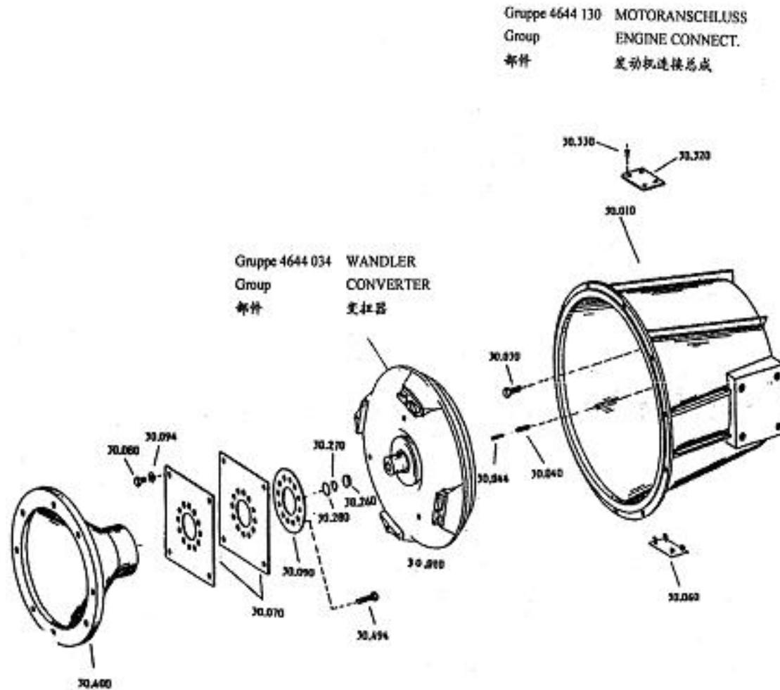
**发动机连接总成 ENGINE CONNECT**
