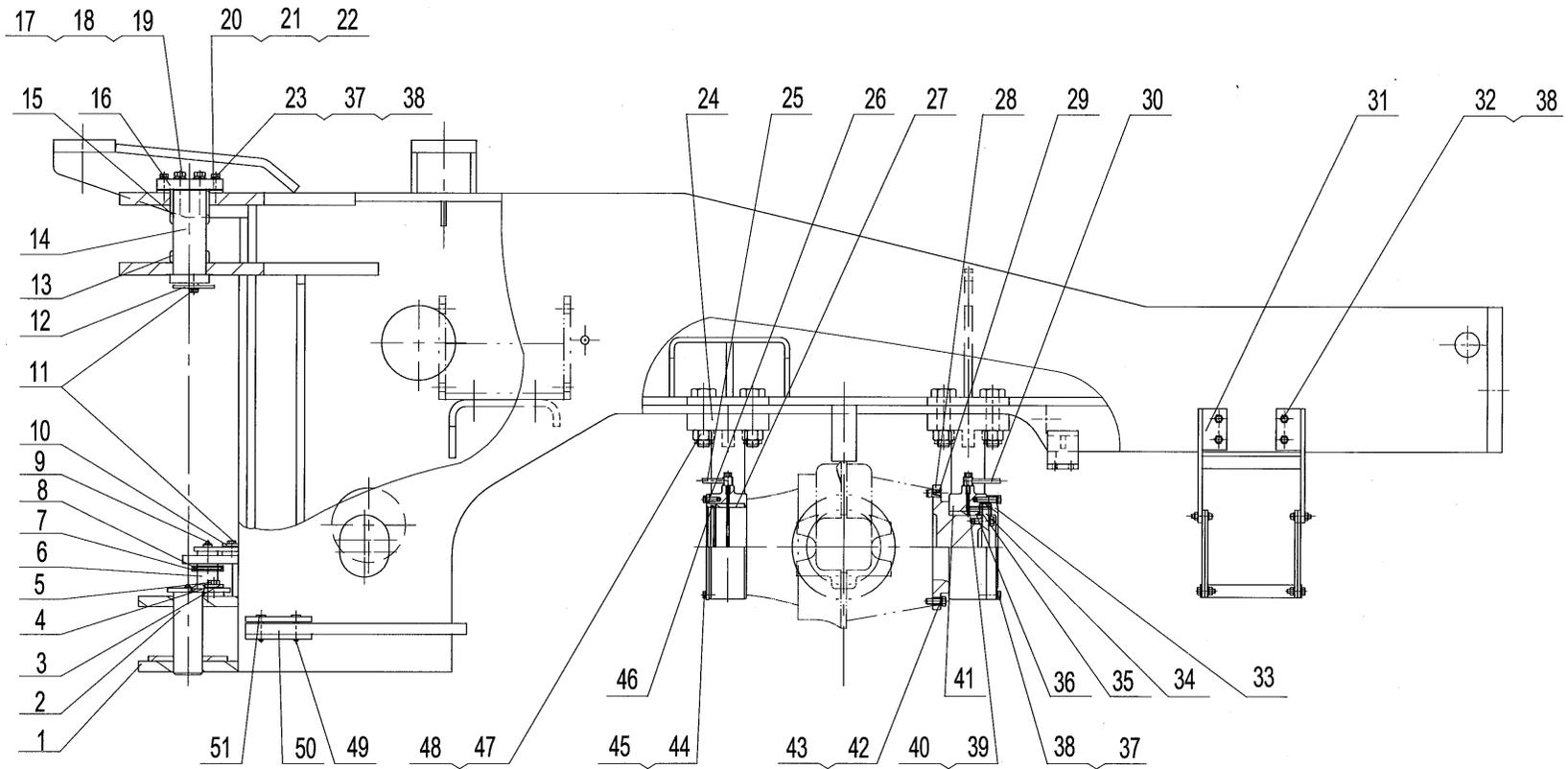
后车架总成 (658) REAR FRAME ASSEMBLY
